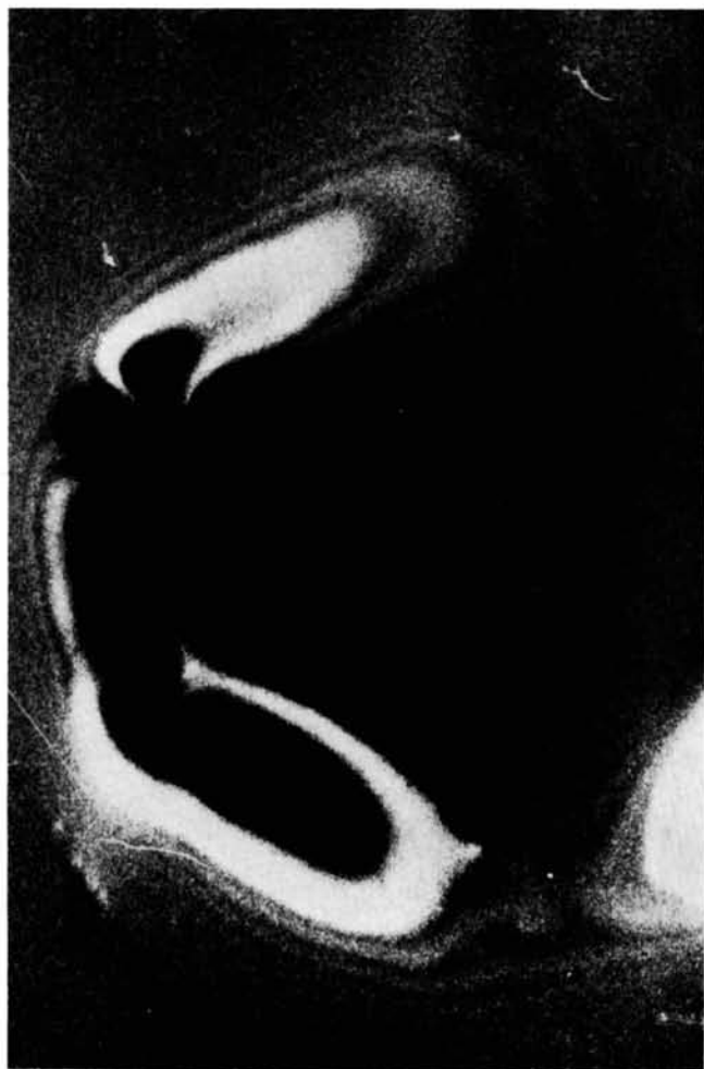
Fig. 5. Reflexionstopogramm [(511)^V, -(333)^S] von Si-Scheibe, Dicken: Aussenring; 1,5 mm, Innenbereich (8 mm dia.): 5–20 \mu .
