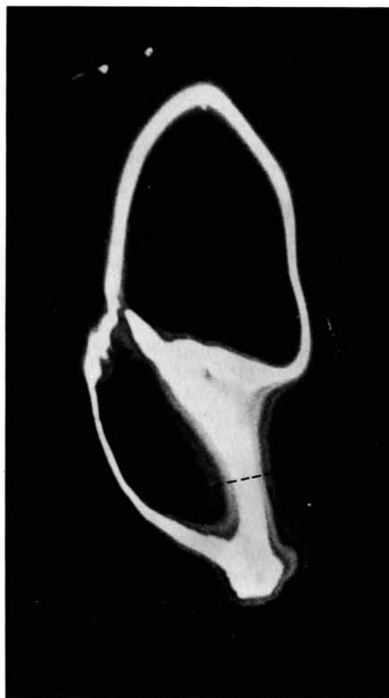
Fig. 5. Reflexionstopogramm [(511)^V, -(333)^S] von Si-Scheibe, Dicken: Aussenring; 1,5 mm, Innenbereich (8 mm dia.): 5–20 \mu .
